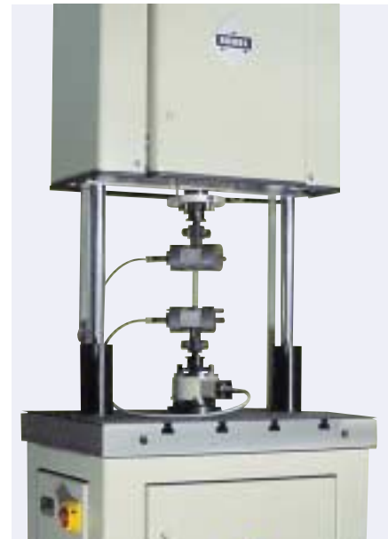
Resonanzprüfmaschine MIKROTRON 5/20 kN
