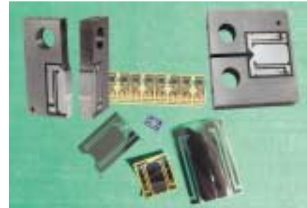
Beispiele für Rissmessfolien
