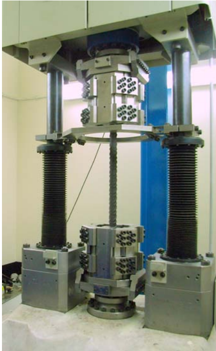
Hydraulische Spannvorrichtung PowerGrip 500 kN für die Prüfung von Betonstählen
