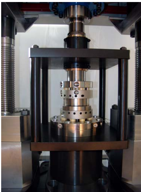
Spezialvorrichtung für Druckprüfungen bei erhöhter Temperatur an Zylinderkopfdichtungen
