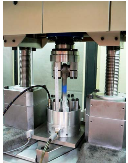
Spezialvorrichtung für Prüfungen an Pleuelstangen
